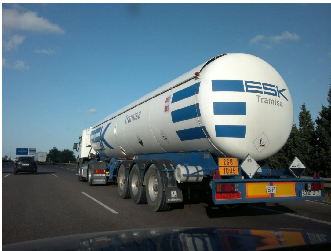
Cisterna de amoniaco anhidro.
