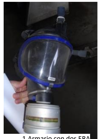
1. Armario con dos ERA completos 2. Mascara completa personal con filtro para amoniaco
