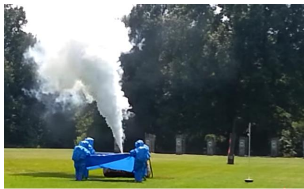
Cubrición de un depósito presurizado de amoniaco anhidro fugando en fase gas. TRANSCAER
