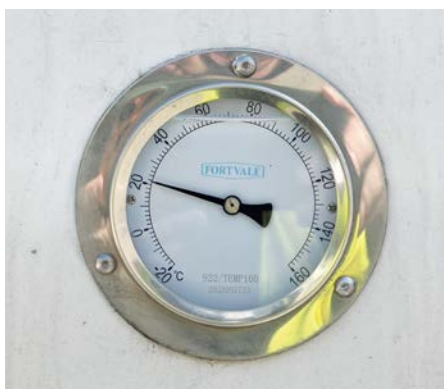
Imagen 39. Termómetro exterior para la medición de la temperatura interior de la cisterna.
