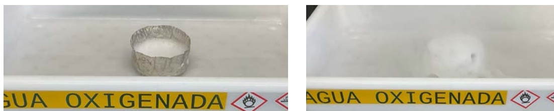
Imagen 17. Descomposición rápida del H_2O_2 al contacto con el platino.
