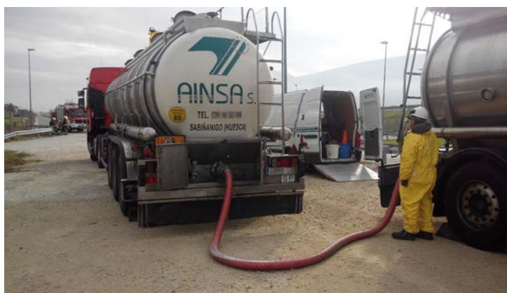
Imagen 48. Trasvase de H_2O_2 entre cisternas en Aldunate (Navarra).
