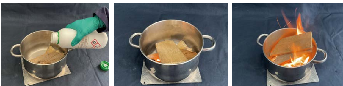
Imagen 26. Demostración del poder oxidante de H_2O_2 con la madera.
