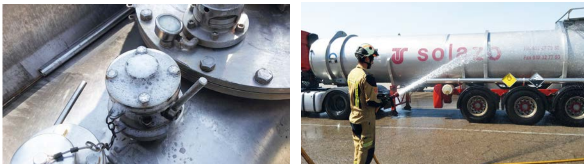
Imagen 50. Descomposición del H 2 O 2 y refrigeración de la cisterna.
