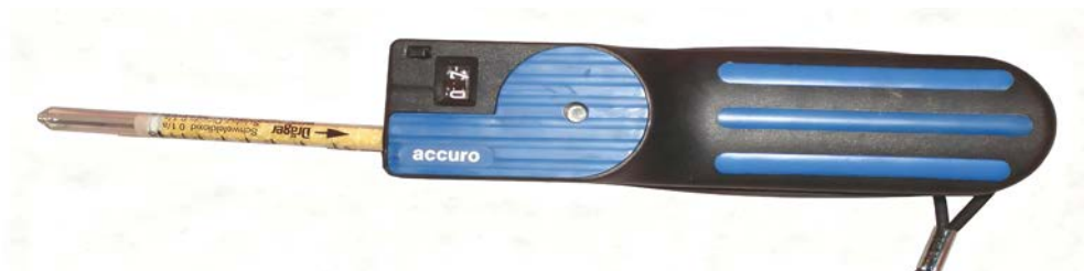
Imagen 42. Tubo colorimétrico Dräger para medición de rango corto y bomba de aspiración.
