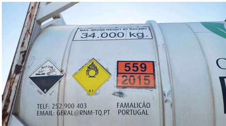
Imagen 11. Panel naranja y etiquetas de peligro en un ISO 49 contenedor.
