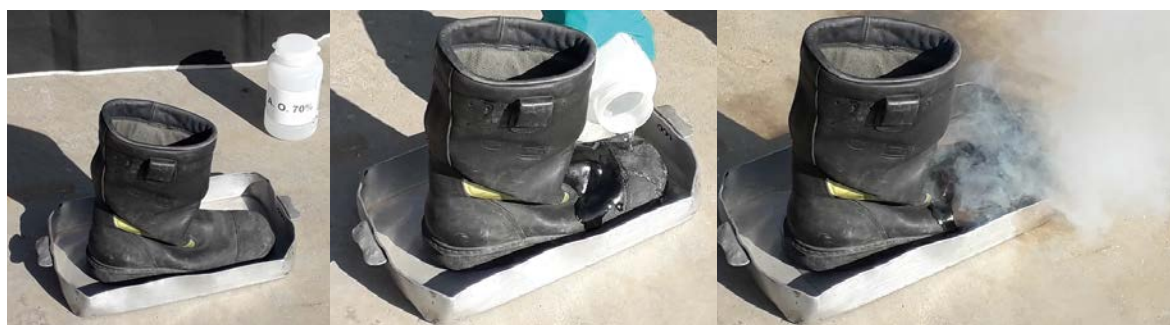
Imagen 49. Reacción del H_2O_2 con la bota de bombero.
