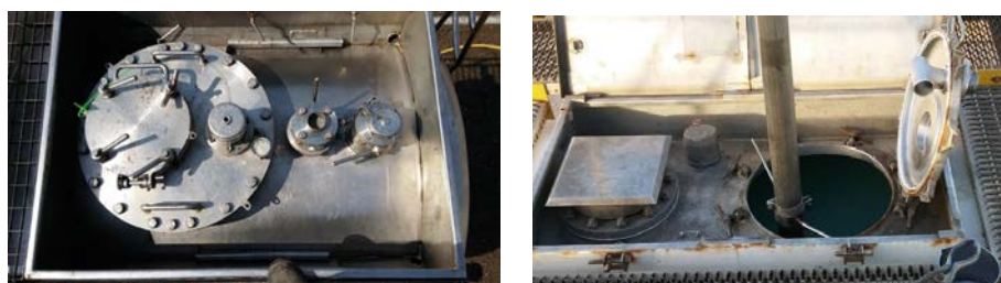
Imagen 37. Cubeta con boca de hombre cerrada y abierta en proceso de carga de cisterna.
