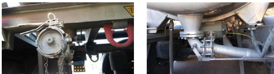
Imagen 34. Cisterna con aberturas de descarga con tres cierres.
