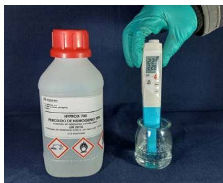
Gráfico 6. Datos del pH aparente del \text{H}_2\text{O}_2 en función de su concentración. Fuente: Solvay. Imagen 4. Medición del pH del \text{H}_2\text{O}_2 al 70 %. (Resultando un pH de 2,29)
