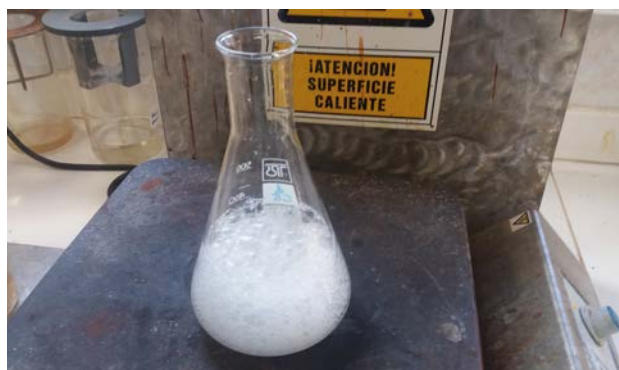
Imagen 6. Calentamiento del \text{H}_2\text{O}_2 y su descomposición.
